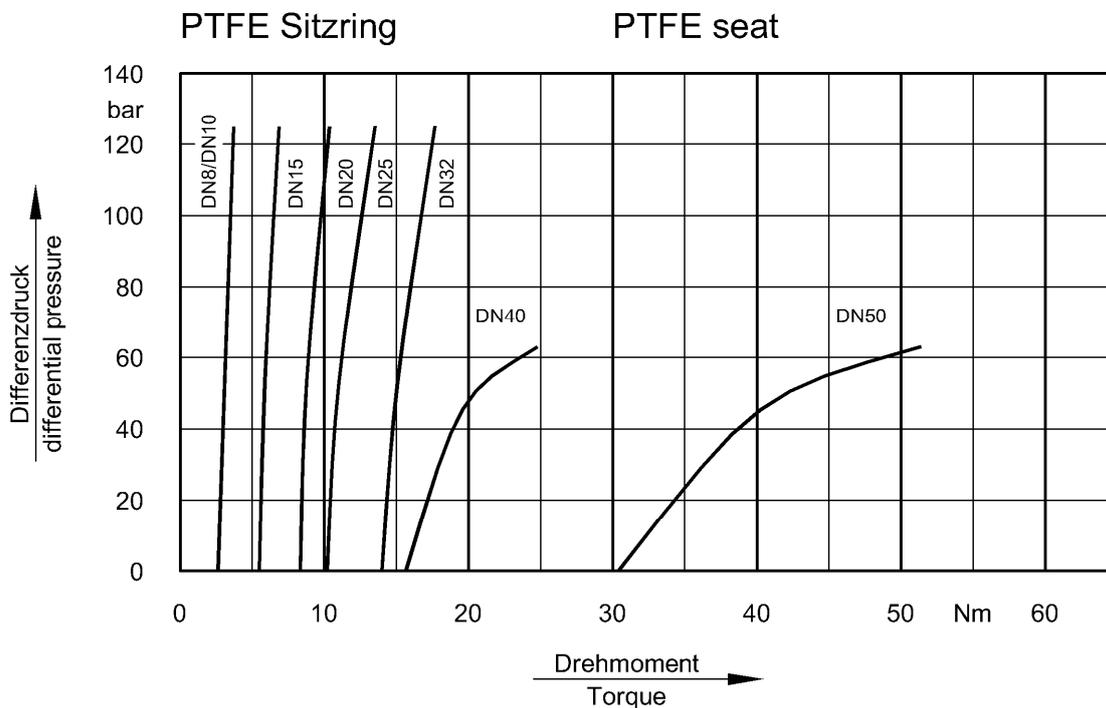
Die Drehmomente beziehen sich auf Kugelhähne mit vollem Durchgang. Für Kugelhähne mit red. Durchgang eine Nennweite kleiner wählen.
