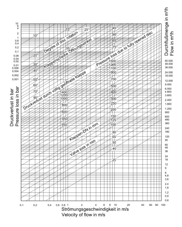
**Anmerkung:** Alle Werte beziehen sich auf Wasser von 15° C. Bei einer Stömungsgeschwindigkeit von über 8 m/s bei voll geöffneter Klappe ist Rücksprache mit dem Lieferwerk erforderlich.
